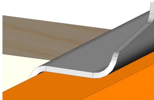
Fästet placeras på läkten och justeras i höjd mot underliggande takpanna, lämplig glipa 2-3 mm, skruva fast konsolen med 2 st M10x20 + mutter
