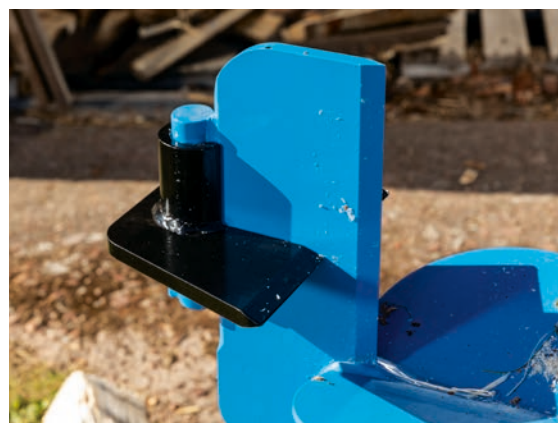
Med 4-skärsenheten som tillhör kan du lätt klyva veden i fyra delar i ett moment.
