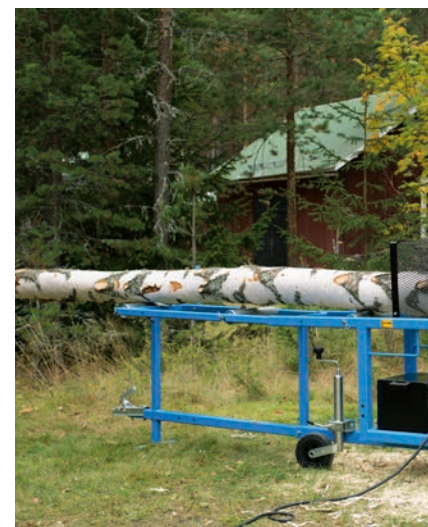
Vedmaskinen är utrustad med kulkoppling och kan dras kortare sträckor med bil eller ATV.
