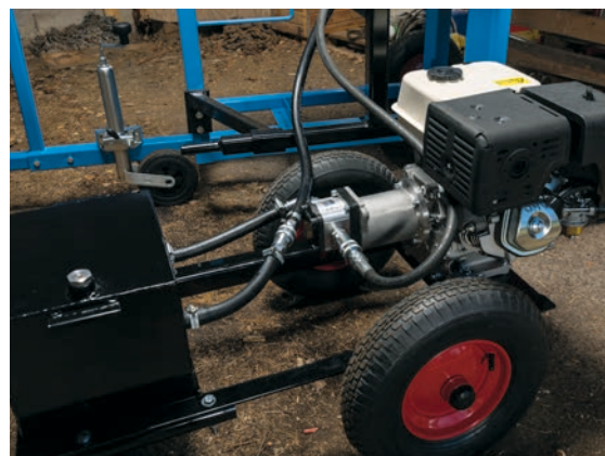
Tryck- och returslang ansluts till hydraulaggregatet.
